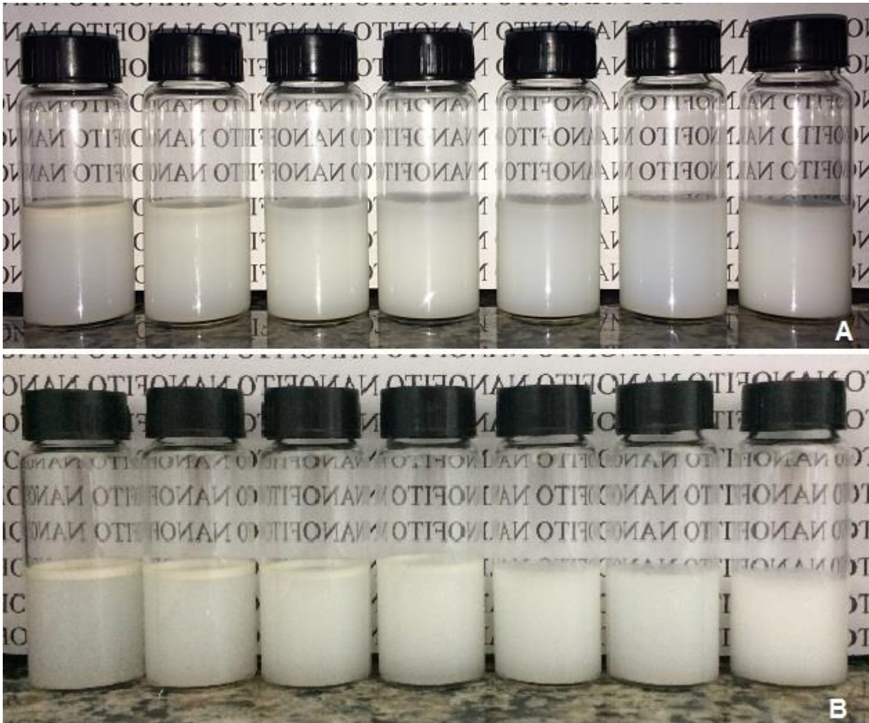
Fig.2. Conjunto de emulsões preparadas com óleo essencial de H. suaveolens e os surfactantes trioleato sorbitano/polisorbato 20 a diferentes taxas (da direita para esquerda: EHLr 10, 11, 12, 13, 14, 15 e 16.7). A: dia 0 de preparação e B: após o dia 7 de armazenamento das nano-emulsões.
