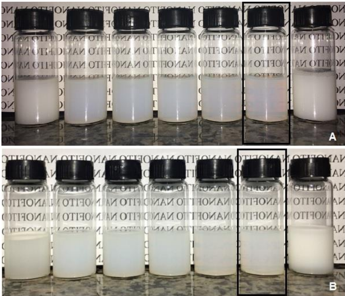
Fig. 3. Conjunto de emulsões preparadas com óleo essencial de H. suaveolens e os surfactantes monoleato sorbitano e polisorbato 20 a diferentes taxas (da direita para esquerda: EHLr 10, 11, 12, 13, 14, 15 e 16.7), em destaque o EHL 15, nanoformulação utilizada no bioensaio. A: dia 0 de preparação e B: após o dia 7 de armazenamento das nano-emulsões.
