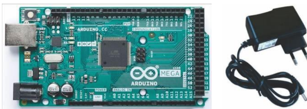
Figura 8 - Módulo 1 MDA: Unidade de programação e processamento. Fonte: Arduino (2018), “Baú da eletrônica” (2018).
