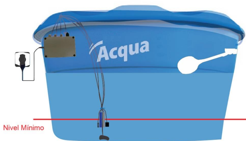
Figura 16 - Exemplo instalação do MDA em caixa d'água. Fonte: Adaptado de InfoAmazonia, 2017.
