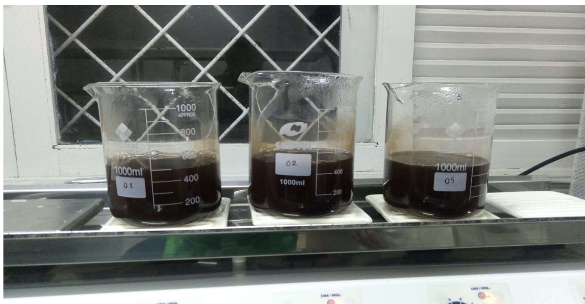
Figura 25 – Cozimento de lignina insolúvel em de ácido sulfúrico a 3%(v/v).
