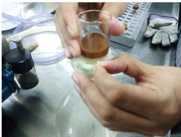
Figura 24 – Remoção de material solúvel em água fria/quente.
