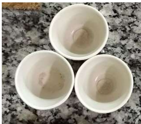
Figura 26 – Cinzas de Dinizia excelsa em cadinhos de porcelana. Fonte: o autor
