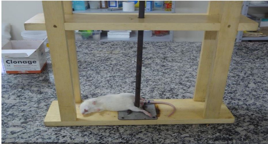
Figura 05: Animal posicionado no aparelho fraturador. O membro posterior do animal fica apoiado sobre dois suportes de 1cm de altura, separados por uma distância de 4cm. Foto do autor
