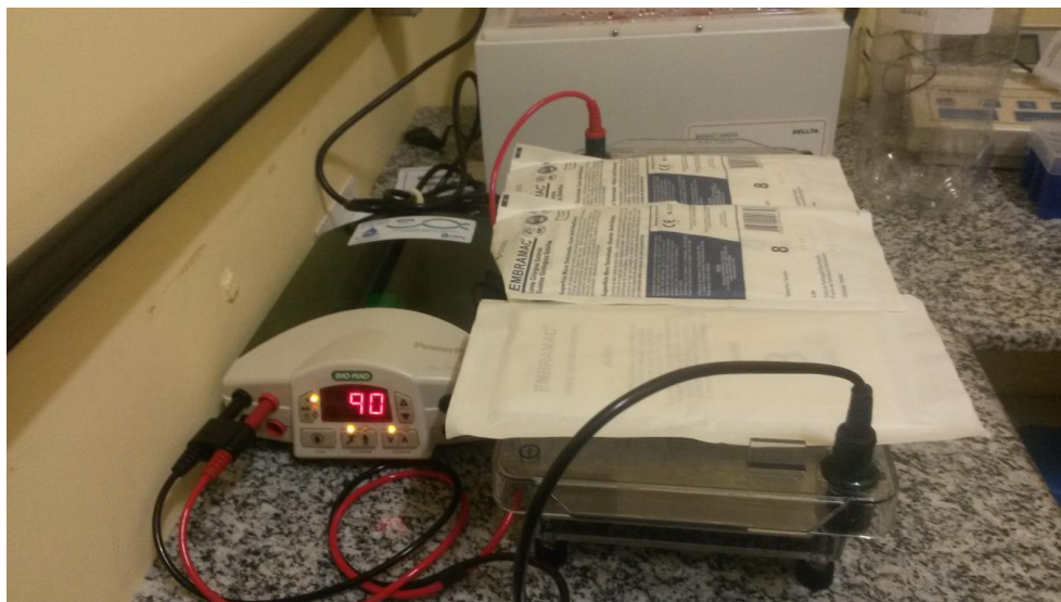
Figura 1. Aparelho para corrida eletroforética do genoma amplificado no PCR.
