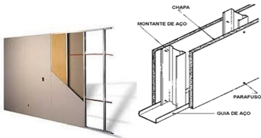
Fig. 78: Parede em Drywall e estrutura de seus componentes.
