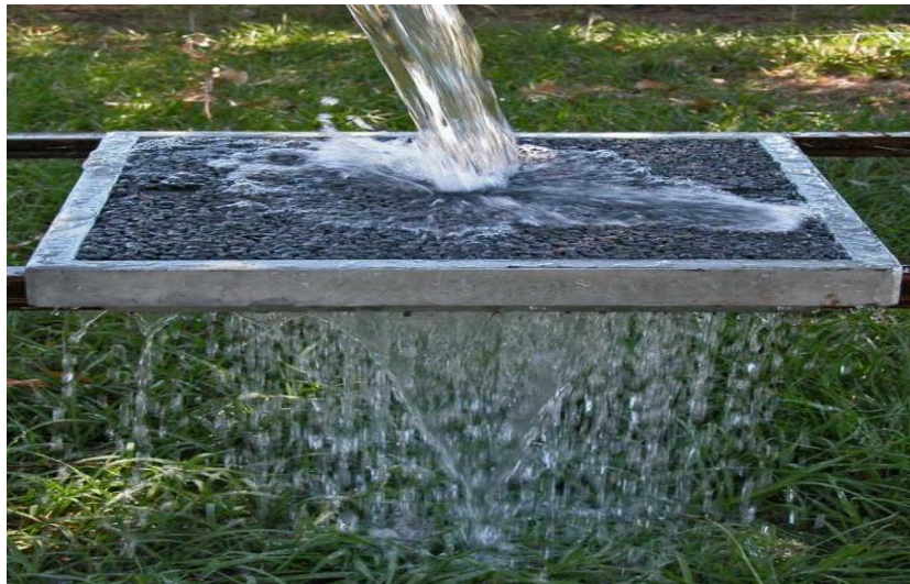
Figura 12: Modelo de pavimentação porosa e a eficiência no escoamento da água.
