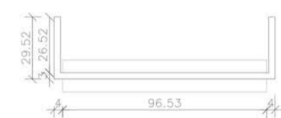
DETALHE 27 - PLANTA BAIXA PROTEÇÃO HORIZONTAL 01 esc 1:25
