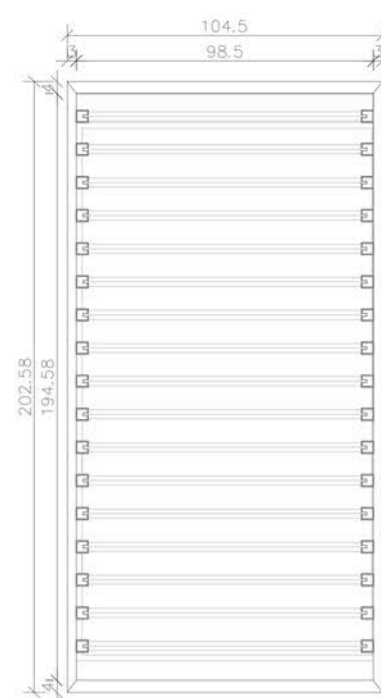
DETALHE 28 - VISTA FRONTAL PROTEÇÃO HORIZONTAL 02 esc 1:25
