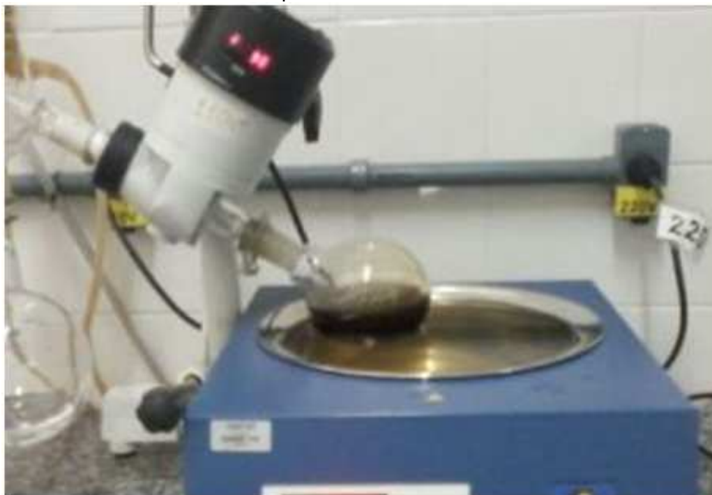
Figura 9 – Processo de concentração de extrato em aparelho evaporador rotativo sob pressão reduzida
