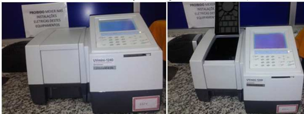
Figura 10 – Espectrofotômetro Shimadzu UVmini-1240 utilizado na leitura das absorbâncias das soluções na região UVB (290-320 nm).
