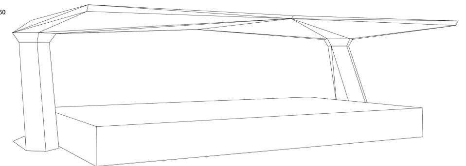
Estrutura dos pilares em concreto armado, acabamento na cor branca, e a cobertura em estrutura metálica tubular e revestida com placas de fibrocimento, finalizado na cor branca.
