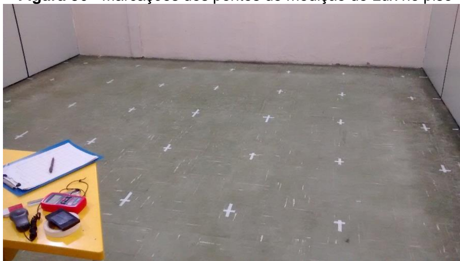
Figura 36 - Marcações dos pontos de medição de Lux no piso
