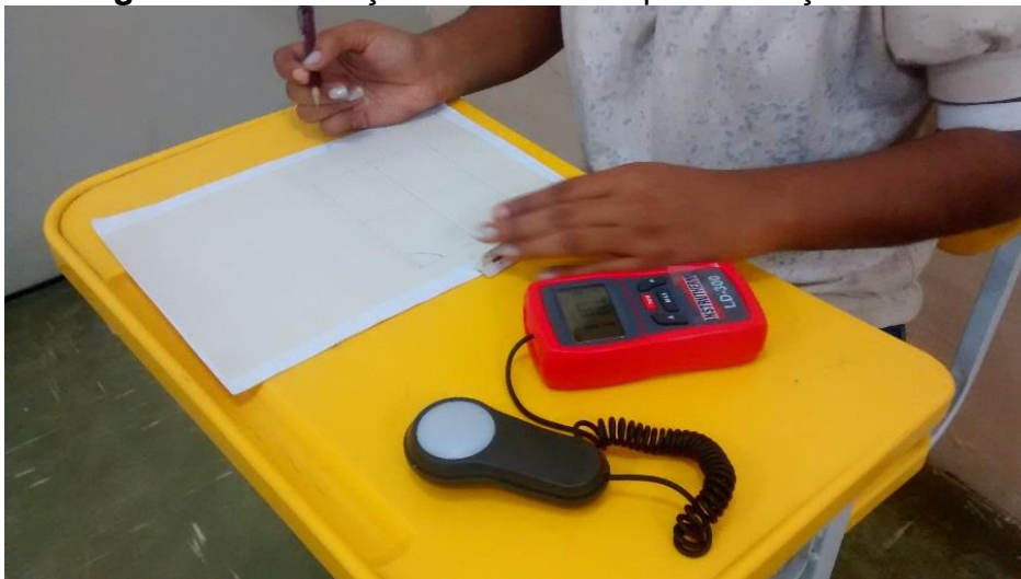
Figura 35 - Utilização do Luxímetro para medição do lux
